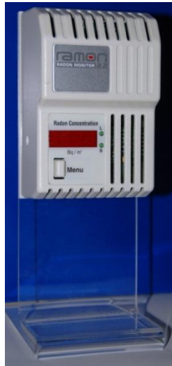
Abbildung 4: Ramon 2.2 Radonmonitor Quelle: Eigenes Foto
