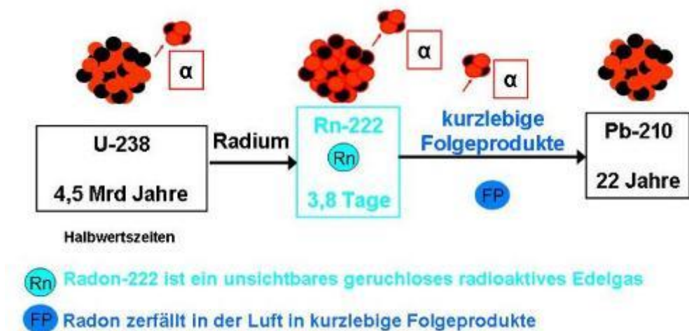
Abbildung 1: Schematische Darstellung Zerfallsreihe Uran 238 zu Radon Quelle: http://www.ksm.kit.edu/img/U238Zerfallsschema.jpg
